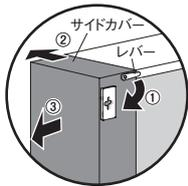
幅広いサイドカバー裏面のレバーを回転させ、矢印の方向に動かしてサイドカバーを取りはずします。
